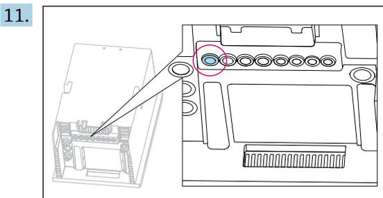
将用户现场自备的供电电缆插入至图示缆塞中。
