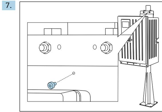
使用包装中的螺丝将上部墙挂支架固定到位。
