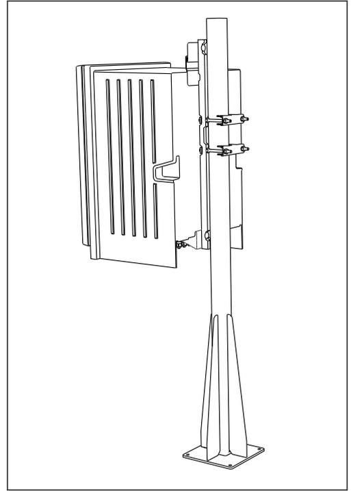
图 24 安装在立柱上的分析仪（从后部）
