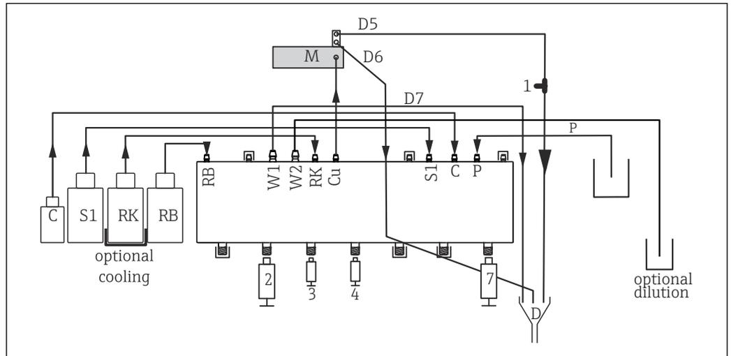
图 66 主动抽取式 Liquiline System CA80PH 分析仪（钼蓝法）
