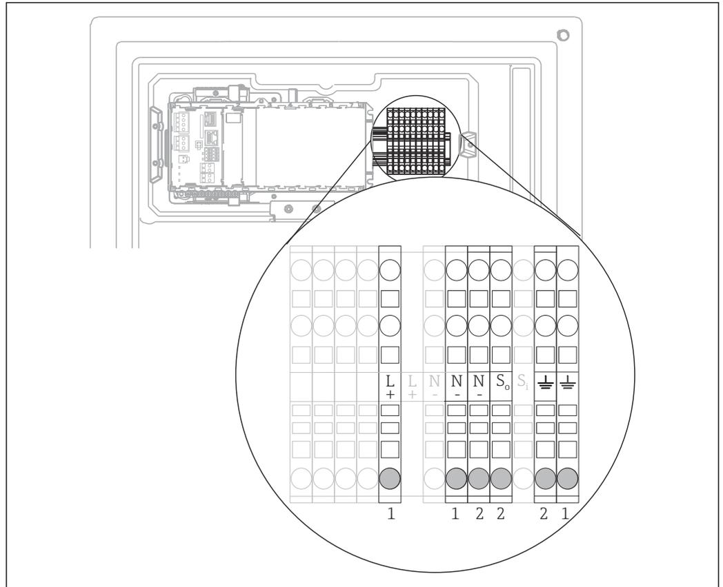
图 26 户外安装型分析仪的接线端子分配
