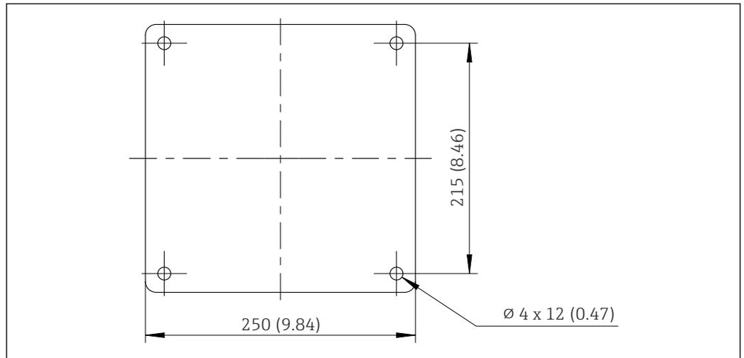
图 22 基础平面图；单位：mm (in)
