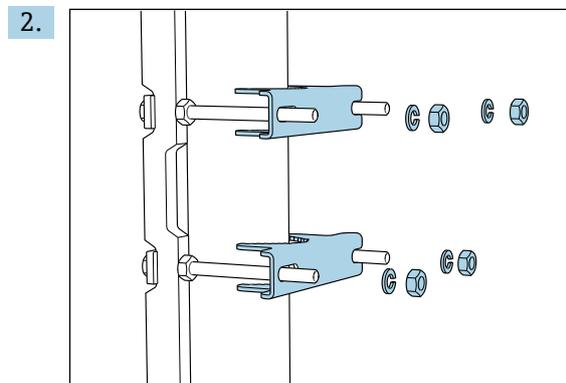
安装对应的部件，并使用弹簧垫圈和螺母固定立柱固定器。
