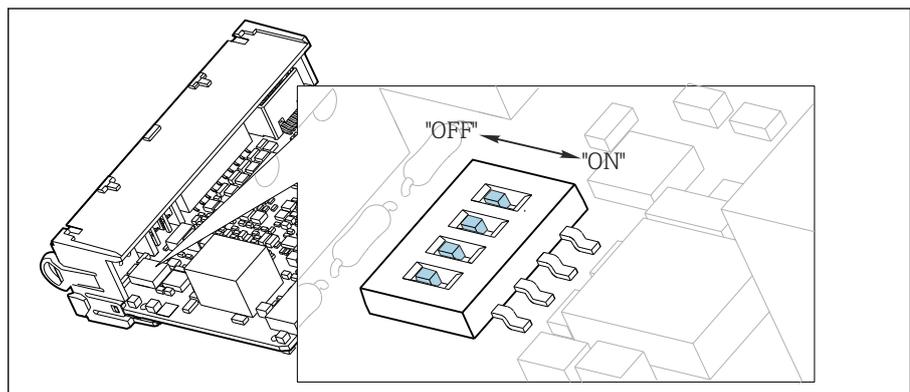
图 53 内部端接的 DIP 开关
