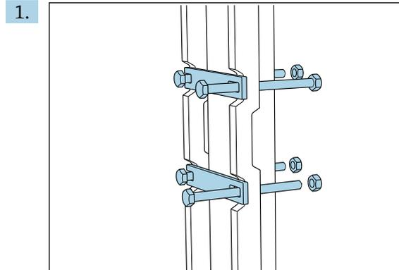
使用螺母将立柱固定器的夹具安装在固定杆和立柱上。
