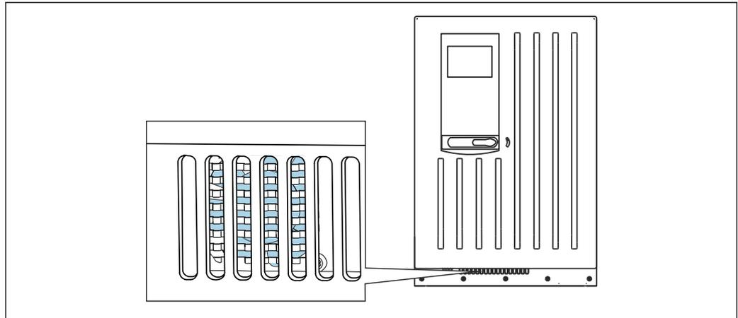
图 81 冷却单元风扇（通风格栅后方）
