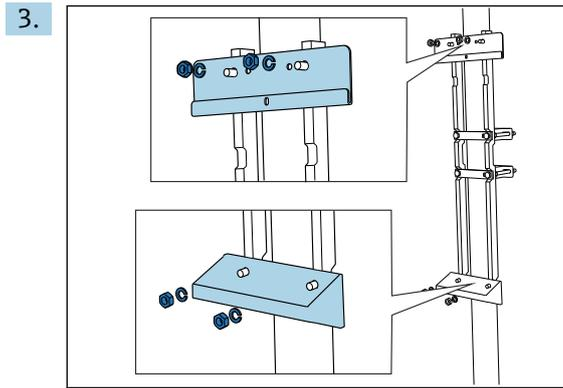
将墙装架（随分析仪一起提供）安装在立柱固定器上。
