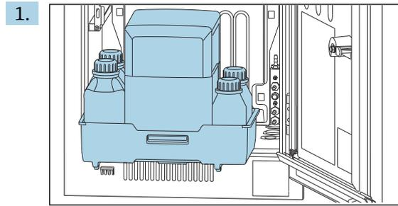
取出托盘：轻抬托盘底部凹槽，向前拉出托盘。
