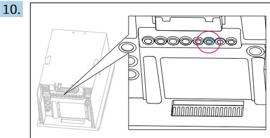
将伴热废液软管电缆插入至图示缆塞中。
