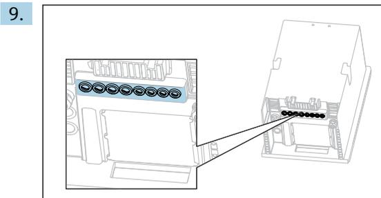
将电缆穿过设备底部的电缆缆塞。
