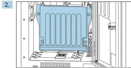
拆除安装就位的盖板。
