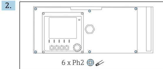
使用十字螺丝刀松开电子腔盖上的六颗螺丝，并向前叠起盖板。
