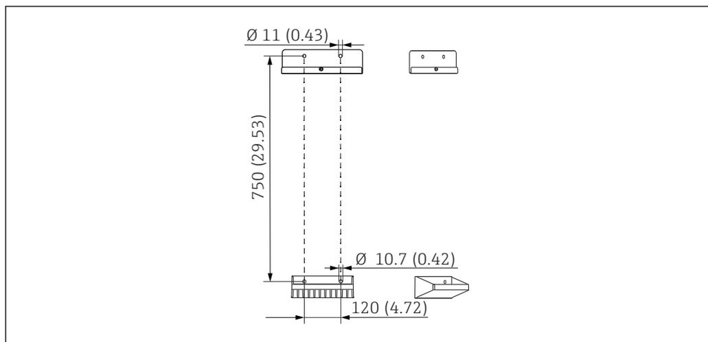
图 18 安装架的外形尺寸示意图；单位：mm (in)
