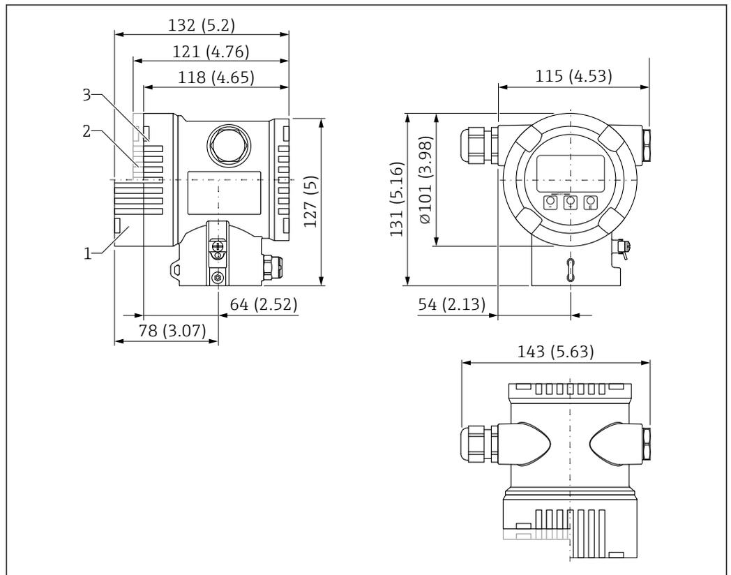
图 32 双腔室外壳的外形尺寸示意图。测量单位 mm (in)
