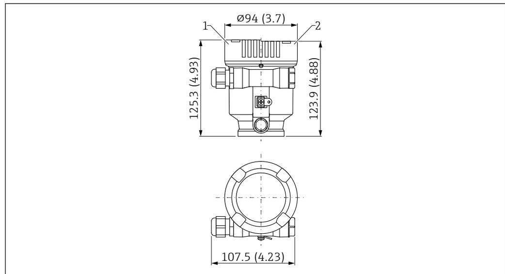
图 29 单腔室塑料 (PBT) 外壳的外形尺寸示意图。测量单位 mm (in)
