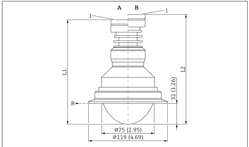
图 39 PTFE 涂层天线（齐平安装，80 mm (3 in) 口径）的外形尺寸示意图；带 ISO2852 Tri-Clamp DN101.6 (4") 卡箍。测量单位 mm (in)
