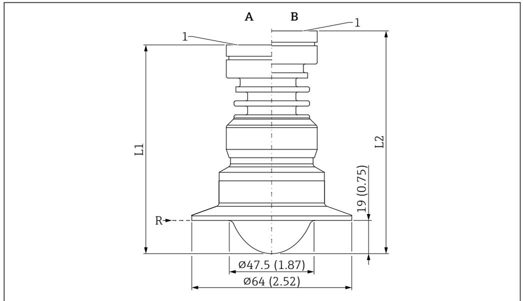
图 37 PTFE 涂层天线（齐平安装，50 mm (2 in)口径）的外形尺寸示意图；带 ISO2852 Tri-Clamp DN51 (2")卡箍。测量单位 mm (in)
