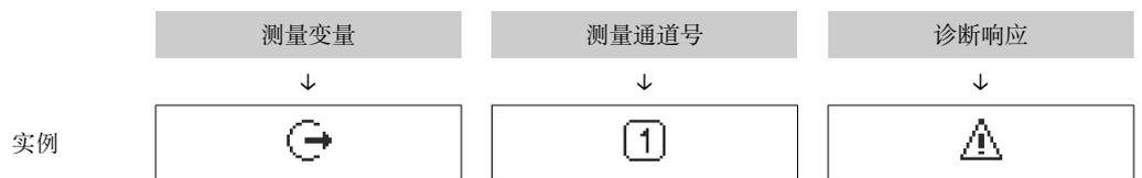
出现与测量变量相关的诊断响应时显示。
