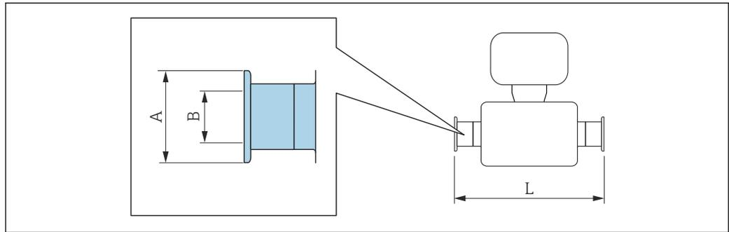
图 66 卫生型卡箍，适用带 ASME BPE 接头的管道（缩径）
