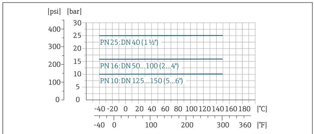
图 47 过程连接材质: 不锈钢 1.4404 (F316L)
