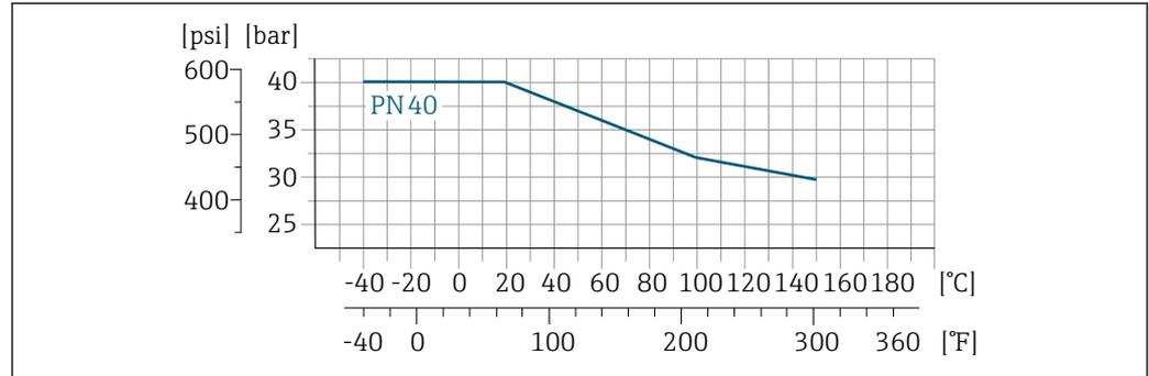
图 33 过程连接材质: 不锈钢 1.4404 (F316L)
