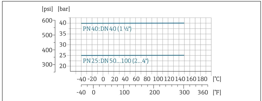
图 46 过程连接材质: 不锈钢 1.4404 (F316L)
