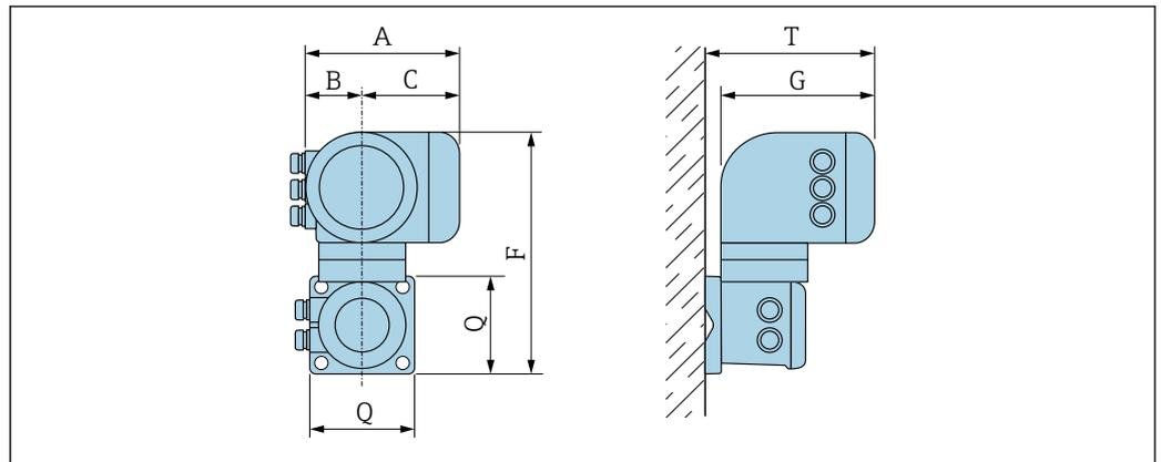
订购选项“变送器外壳”，选型代号 A “铝外壳，带涂层”和订购选项“内置 ISEM 电子模块”，选型代号 B “变送器”
